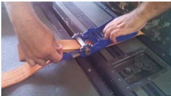
Figura 4.5: Fechamento com a cinta
