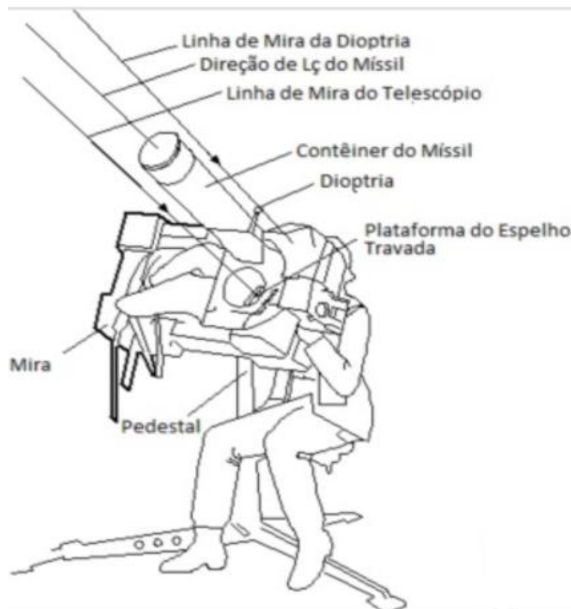
Figura 2 - Sistema de pontaria e acompanhamento do posto de tiro Fonte: Brasil, 2015
