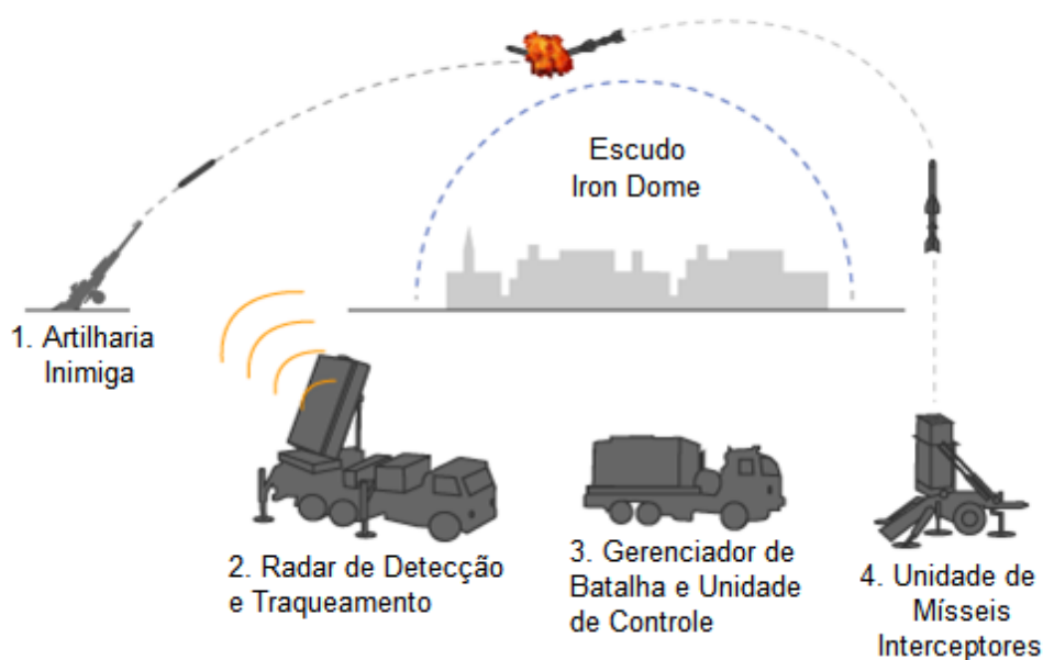
Figura 04 – Esquema de Funcionamento do Sistema Iron Dome Fonte: < http://www.bbc.co.uk/news/world-middle-east-20385306 >
