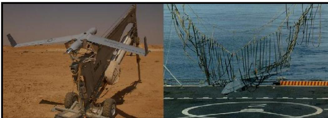
**Figura 2: Subsistema de lançamento e recuperação**
