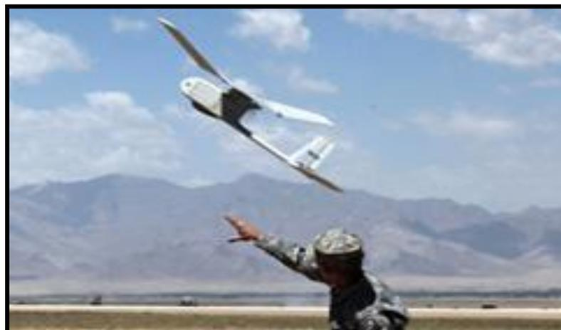
**Figura 20:** ARP do sistema Raven sendo lançada a mão por um militar americano.
