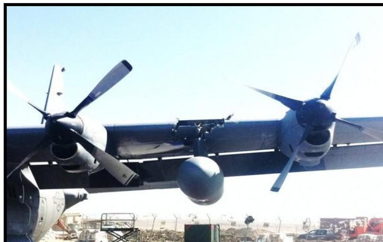
**Figura 30 – Avarias na aeronave C-130 caudas pela colisão com um SARP RQ-1 Shadow**
