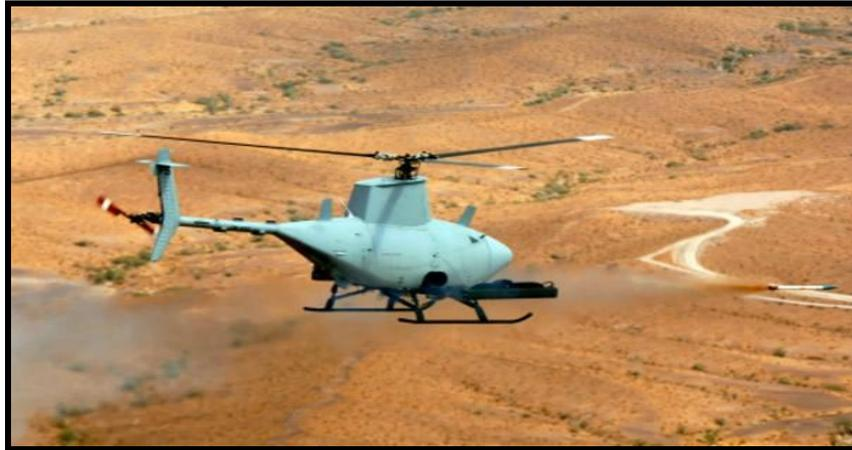
**Figura 19:** ARP do sistema Fire Scout testando o lançamento de foguetes não guiados de 70mm.
