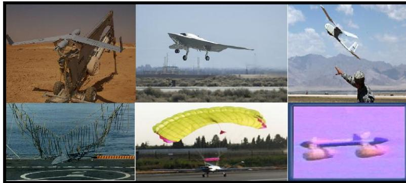
**Figura 9 – Tipos de subsistema de lançamento e recuperação**
