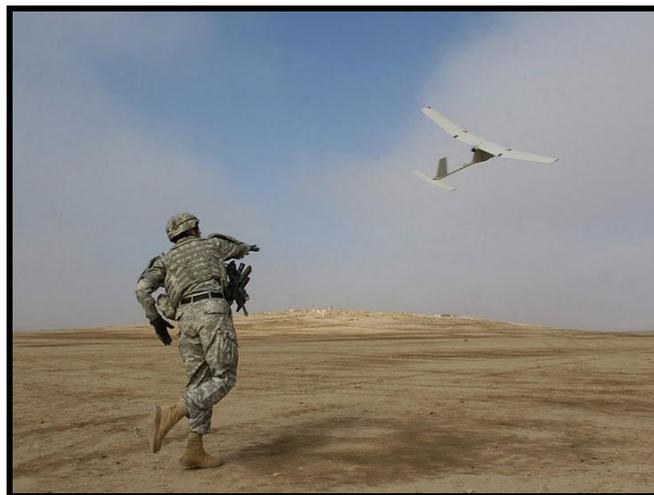
**Figura 26: Mini-ARP Raven sendo lançada por um Militar americano**
