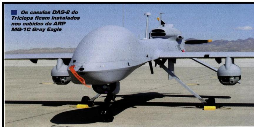
**Figura 28:** Casulos de câmeras adicionais instalados nas asas da ARP do sistema MQ-1C *Gray Eagle*
