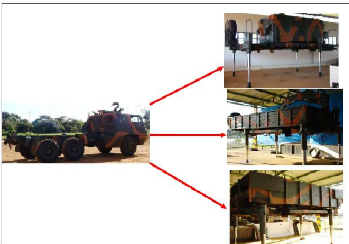
Figura 10. AV-VBA e os módulos de cada viatura. De cima para baixo estão os seguintes: AV-EDT (AV-UCF); AV-CCA (AV-RMD); AV-PLM (AV-LMU)
