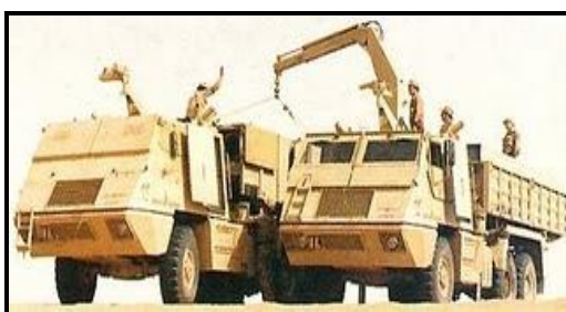
Figura 8 – AV-RMD realizando o remuniamento de uma AV-LMU
