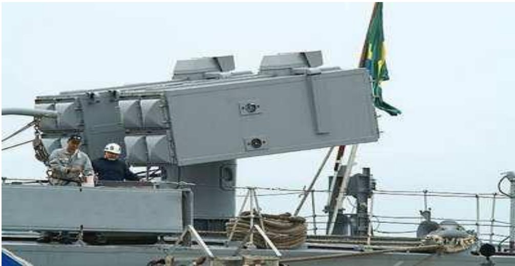
Figura 2 – Sistema Albatros/Aspide das Fragatas classe Niterói
