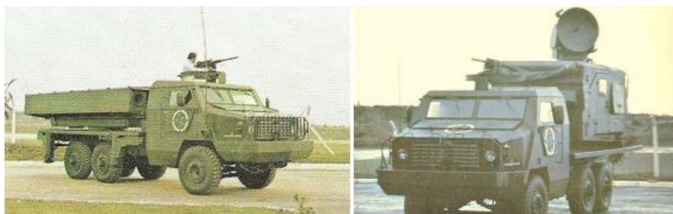
Figura 2 – Primeira Versão do Sistema ASTROS (Brucutu); veículo lançador e diretora de tiro Fonte: Catálogo da AVIBRAS
