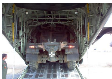
Figura 31 – Embarque da viatura básica (ASTROS) em aeronave C-130
