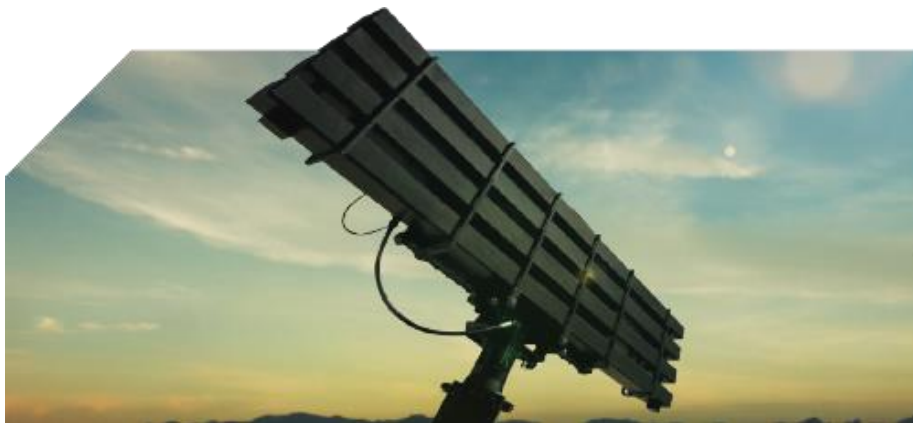
Figura 5.5- Antena do Radar SABER M60 Fonte: http://www.embraerds.com - acesso em 03 Ago 17.
