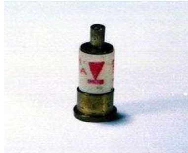
Fig 5.3 – Transmissor de Estado Sólido Diodo tipo Gunn Fonte: EB60-ME-23.014 Manual de Ensino Princípios Básicos de Radar, p. 8-21.
