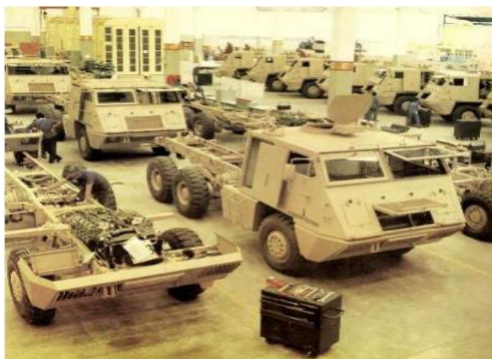
Figura 12 – Chassi depois de modificado e na linha de produção para Arábia Saudita Fonte: < http://www.ecsbdefesa.com.br/fts/ASTROSII1.pdf >
