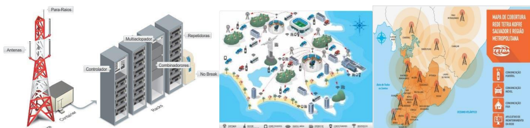
Figura 5: Sistema Rádio Digital Troncalizado (SRDT). Fonte: http://www.kofre.com.br/solucoes/sistematrunking . Acesso em 22 de julho de 2017
