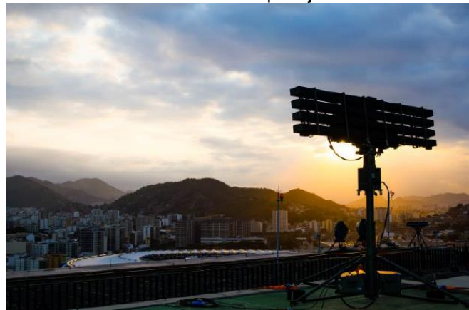
Figura 4 – Radar SABER M60 em operação durante os JOP 2016
