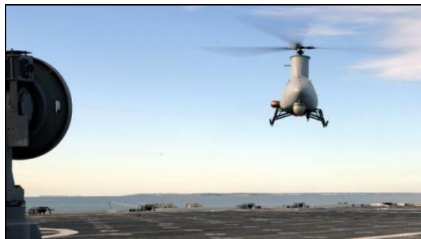
Figura 12: Lançamento de um Fire Scout por meio de decolagem vertical.
