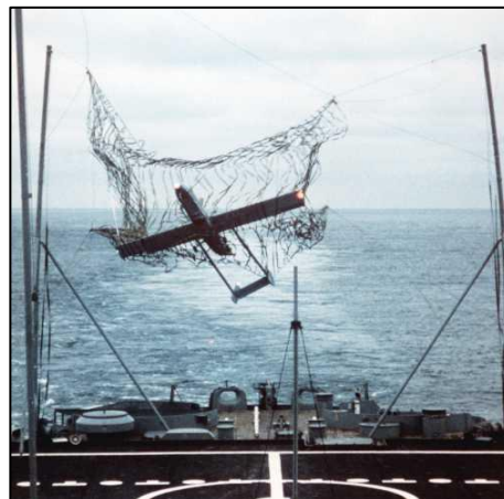
Figura 13: Recuperação de um RQ-2 Pioneer por meio de redes.
