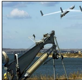
Figura 11: Lançamento de um ScanEagle através de catapulta.
