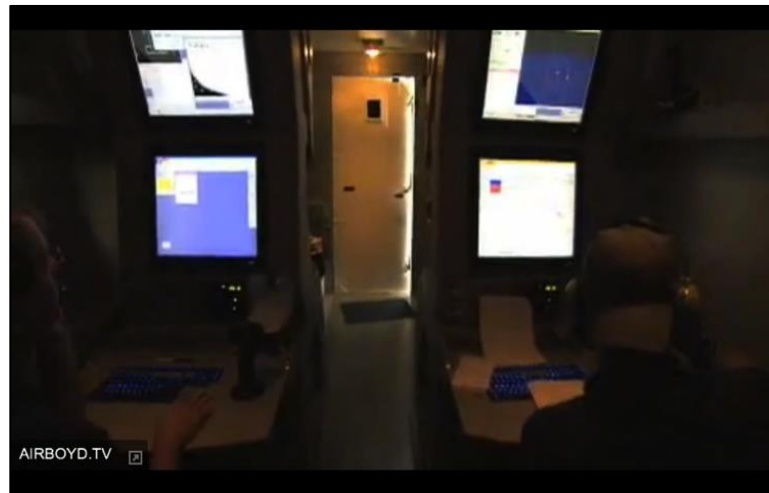
Figura 9: Estação de controle embarcada do SARP Fire Scout Fonte: http://wn.com/Future_Weapon_Fire_Scout_Uav Acesso em: 05 Jul 2013.
