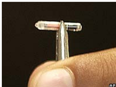
Figura 3.3 – Exemplo de um chip RFID Fonte: BBC Brasil (2004)
