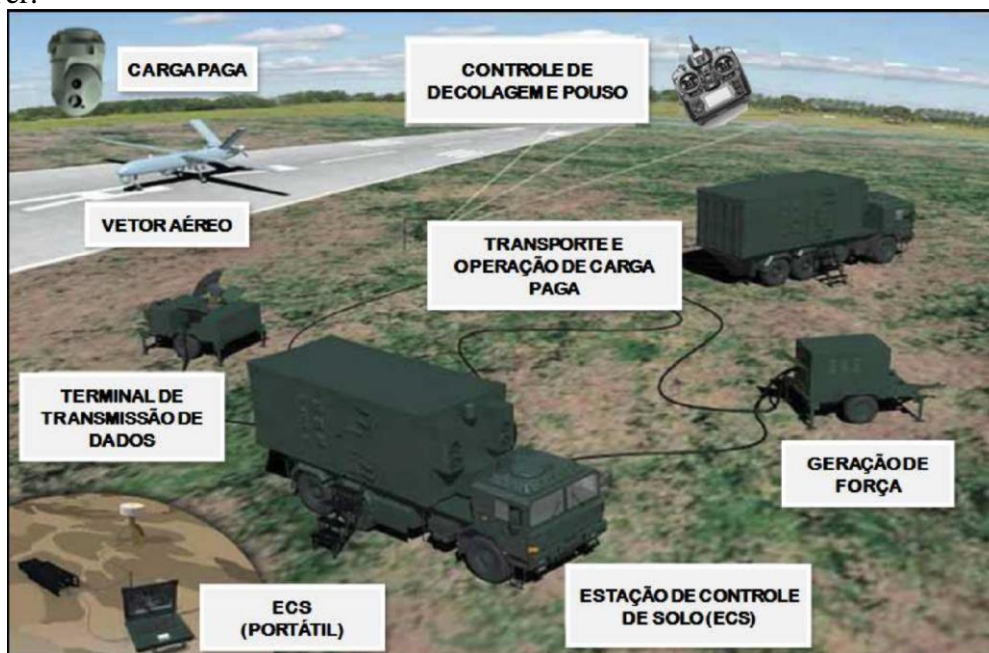
Figura 1 – Desdobramento genérico dos módulos funcionais típicos dos SARP empregados pela F Ter.
