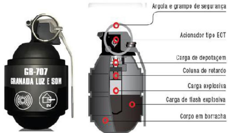
Figura 14 - Esquema de granada indoor luz e som
