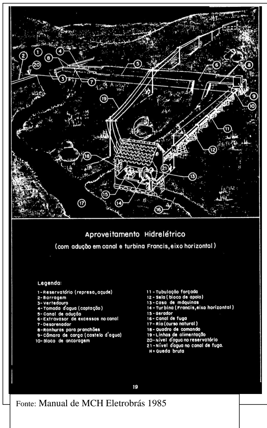
Figura 2: Microcentral Hidrelétrica e componentes
