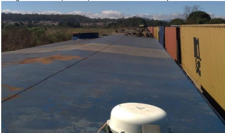
Figura 20: BGAN (Inmarsat) instalado em trem de transporte de Guaranis
