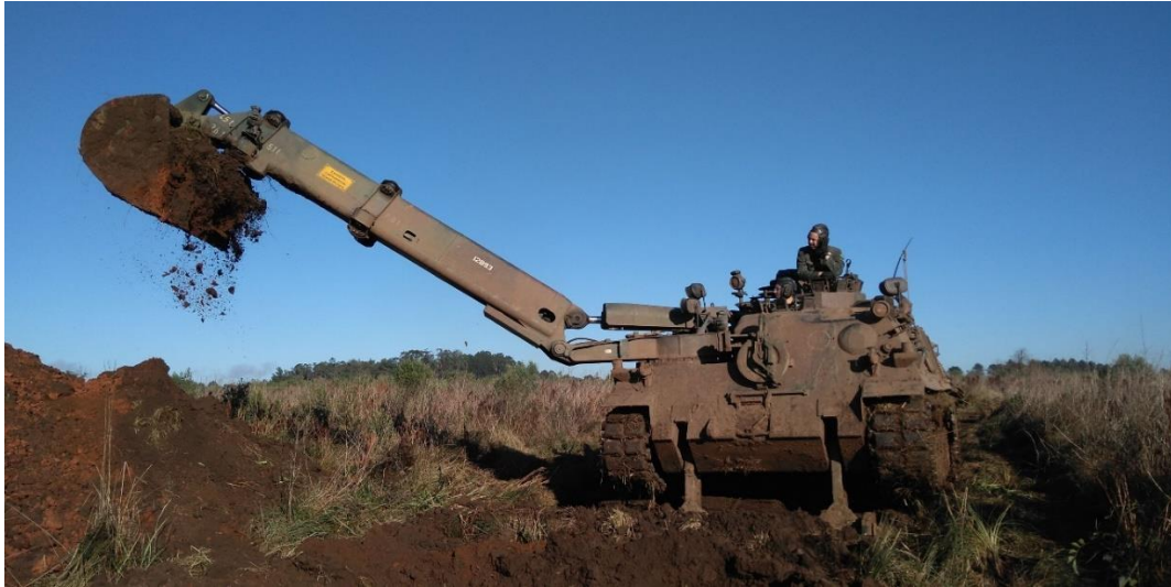
FIGURA 16 - VBE Eng operando sistema de escavadeira.
