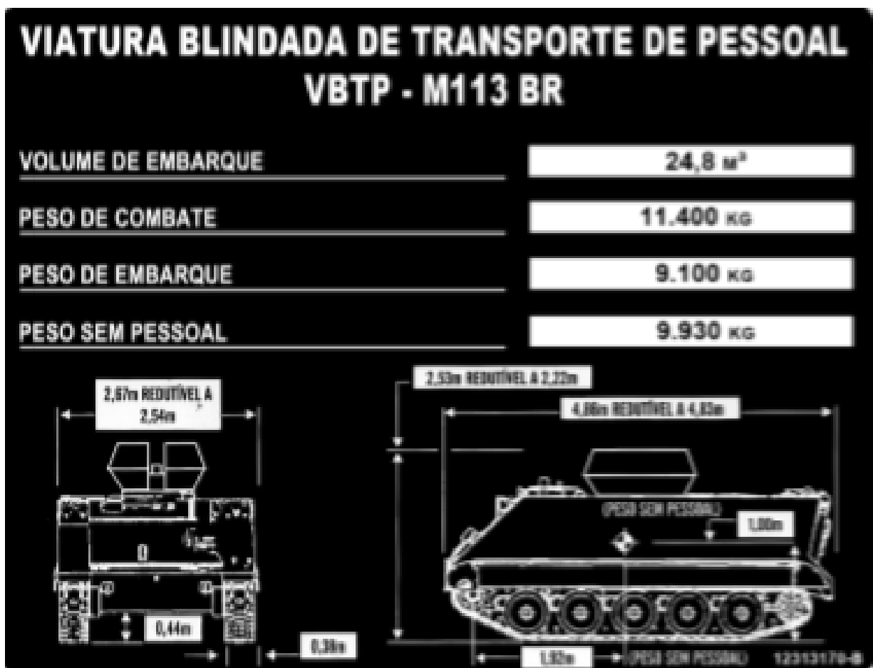
Figura 5: Dimensões da VBTP M113 BR
