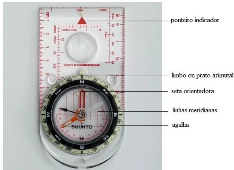
Figura 1 – exemplo de bússola de orientação ou bússola de campo
