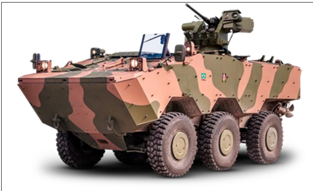
FIGURA 24 – VBTP-MSR GUARANI com Sist A REMAX Fonte: Arquivo 15ª Bda Inf Mec
