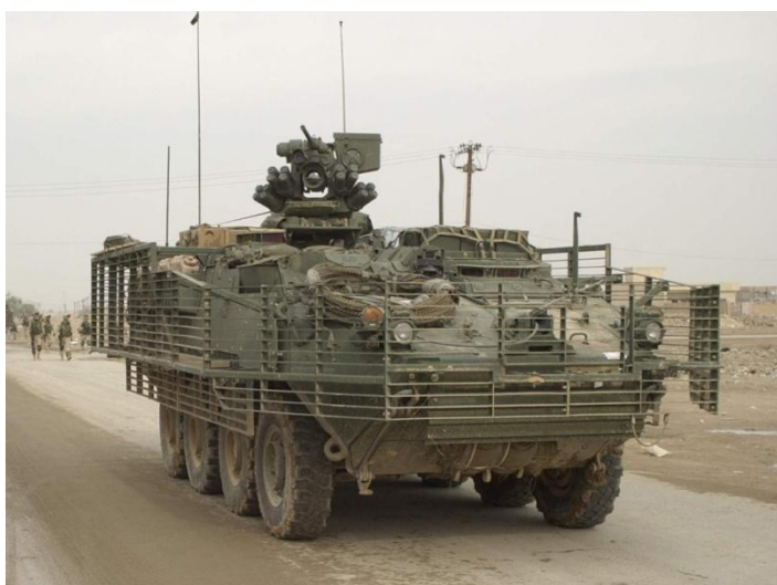
Figura 6 – Viatura Stryker com blindagem gaiola
