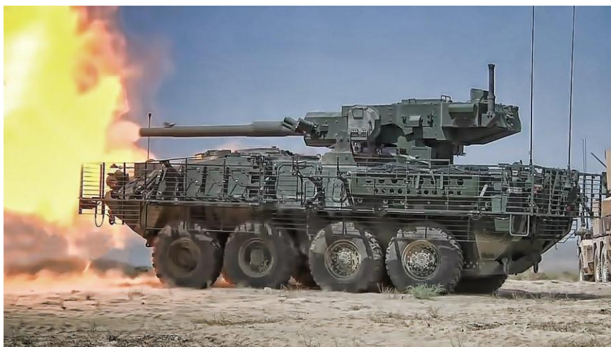
Figura 8 – Viatura Stryker utilizando canhão 105mm
