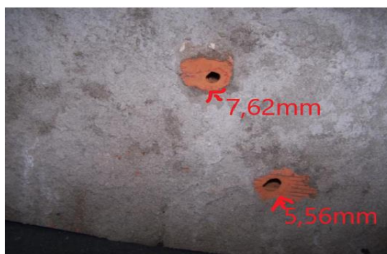
Figura 6 - Impactos de munições 5,56 mm e 7,62 mm, respectivamente, numa parede de tijolo de aproximadamente 10 cm
