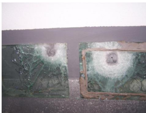
Figura 7 - Impactos de munições 5,56 mm e 7,62 mm, respectivamente, em vidros balísticos
