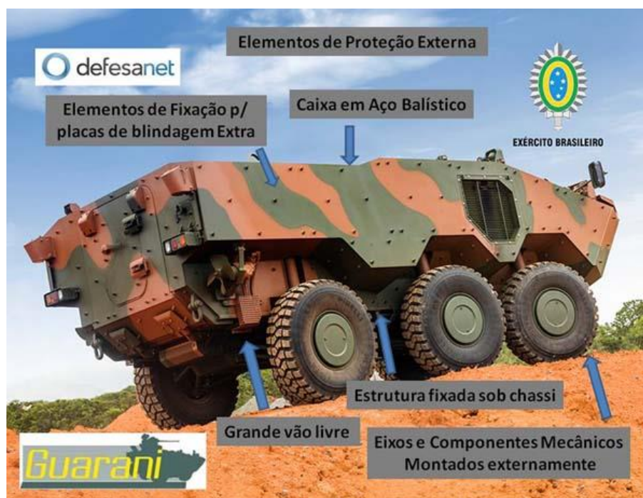
Figura 8: As Características de Proteção Adotadas no Projeto da Viatura Guarani
