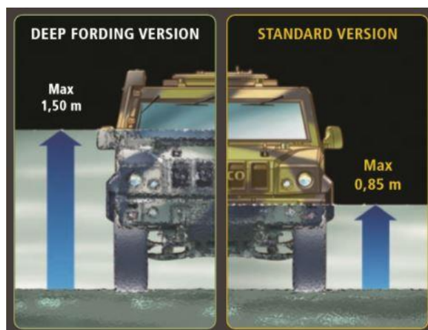
Figura 5 – Possibilidade de submersão Iveco LMV
