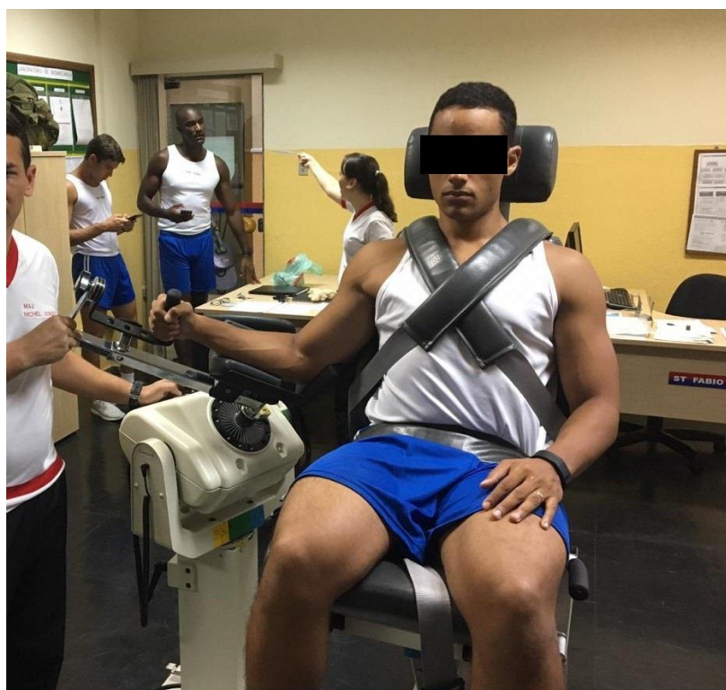
Amostra posicionada na cadeira do dinamômetro isocinético Biodex System 4 Pro.
