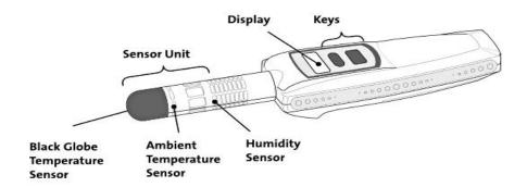
FIGURA 1. Medidores portáteis modernos para a prevenção da doença do calor através do índice WBGT. Estão equipados com um globo muito menor para medir o GT. A temperatura medida é convertida no globo de 24 mm de diâmetro para um globo preto padrão de 150 mm de diâmetro. A medida da "WB" não é direta: Essa temperatura é calculada com base na umidade relativa (medida com um sensor embutido) e na temperatura ambiente.
