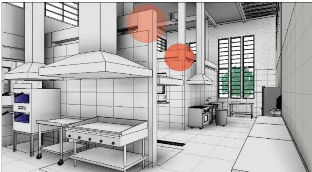
Figura 6 – Vista de interferência de projeto estrutural com alvenaria
