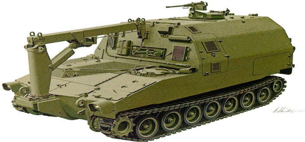
Figura 5 – Viatura Blindada Especial Remuniciadora (VBE Remn) M992A2 Fonte: Fernando (2018)
