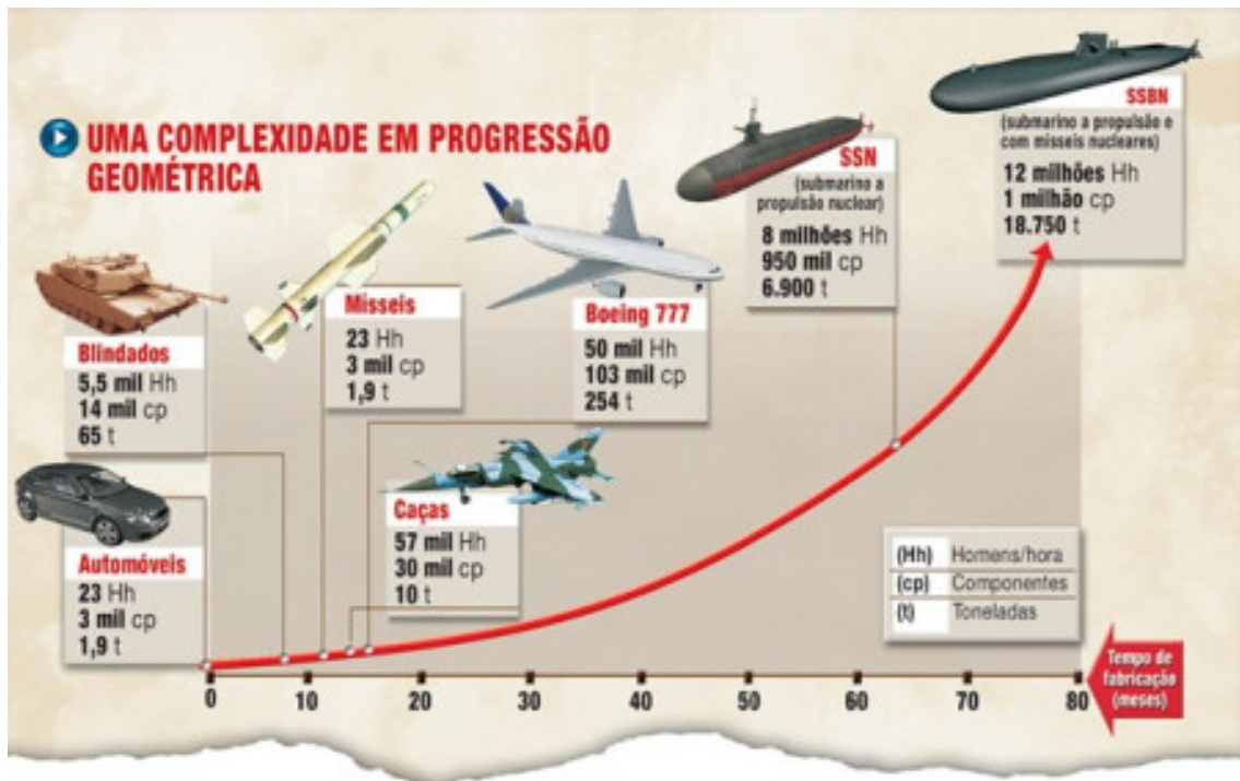
FIGURA 5 - COMPLEXIDADE PARA CONSTRUÇÃO DE SISTEMAS DE DEFESA E TECNOLOGIA
