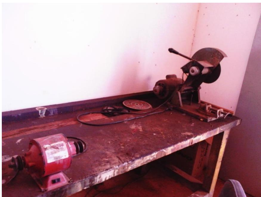
Figura 03: Bancada de cisalhamento de armamento
