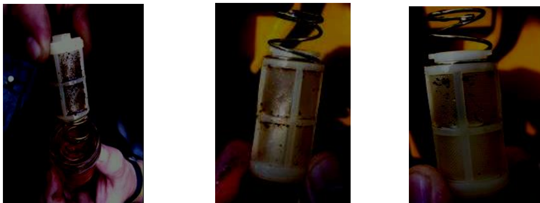
FIGURA 9 - Vista da tomada de combustível diesel (pescador) antes da aditivação e depois da aditivação com A550 da Actioil, 30 e 45 dias.
