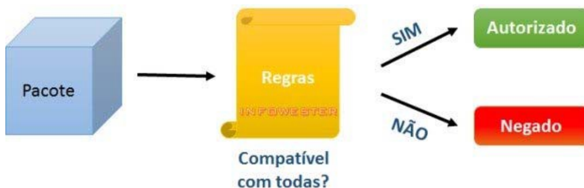
Figura 2: Exemplo de funcionamento de um Firewall Fonte: (ALECRIM, 2013)
