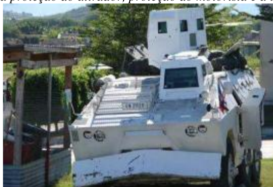
Figura 10 – Urutu com a proteção do atirador, proteção do motorista e a lâmina frontal instalados.
