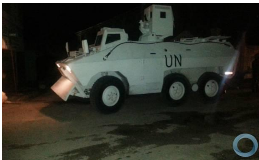
Figura 8 – Imagem lateral do Urutu com a lâmina limpa trilhos instalada
