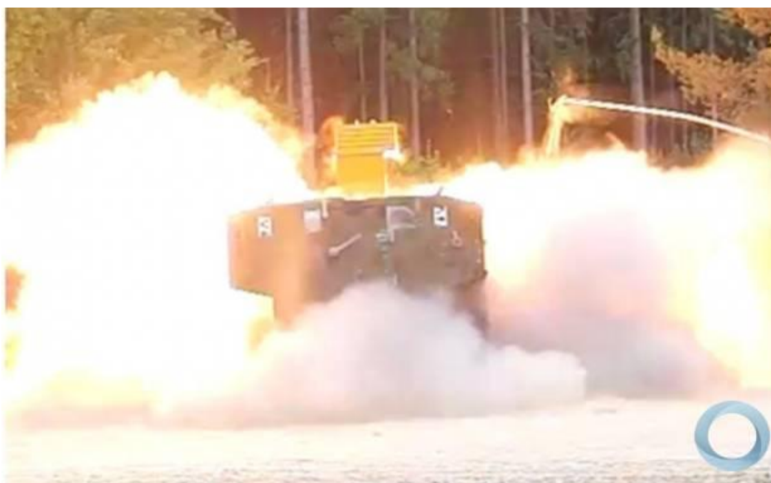
Figura 7: Teste anti-minas na VBTP-MR GUARANI
