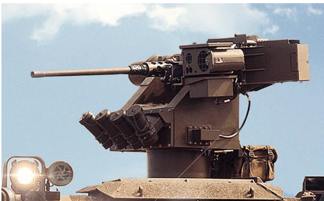
Figura 9: Reparo Automatizado de Metralhadora, REMAX-CTEx
