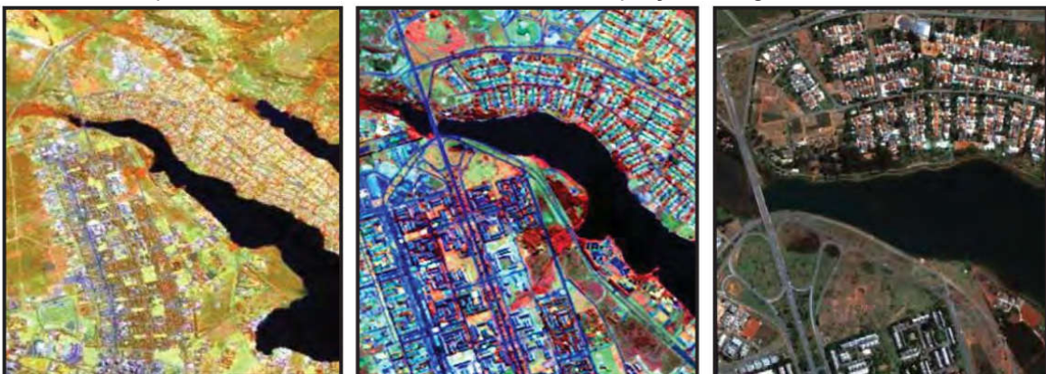
Fig. 3: Da esquerda para a direita, imagens dos satélites, o Landsat com resolução espacial de 30m, o Spot com 10 m e o Ikonos com 1 m, de uma porção do lago Paranoá de Brasília.
