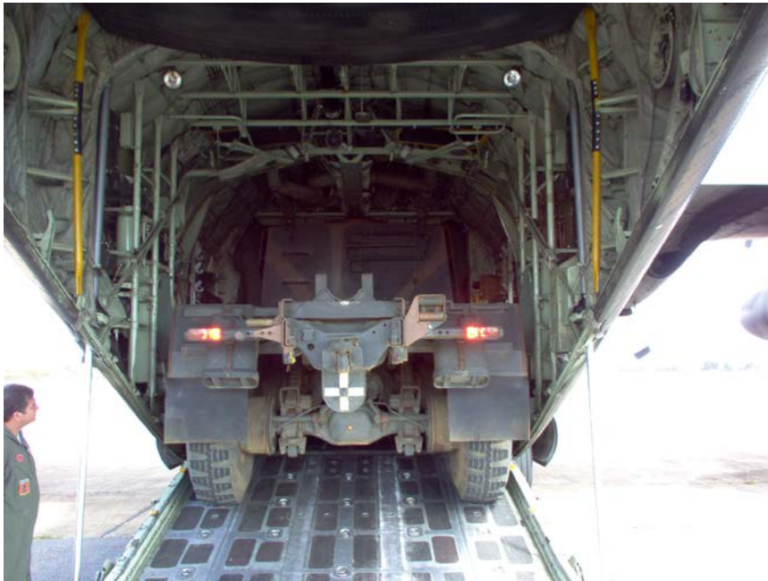
Figura 6 - Teste de embarque em aeronave C-130 realizado na Base Aérea de Brasília em agosto de 2007
