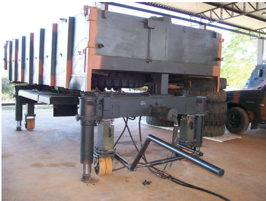
Figura 7 - Kit de embarque para o acoplamento da AV-LMU desenvolvido pelo 1º Ten QEM Olivieri do 6º GLMF/CIF
