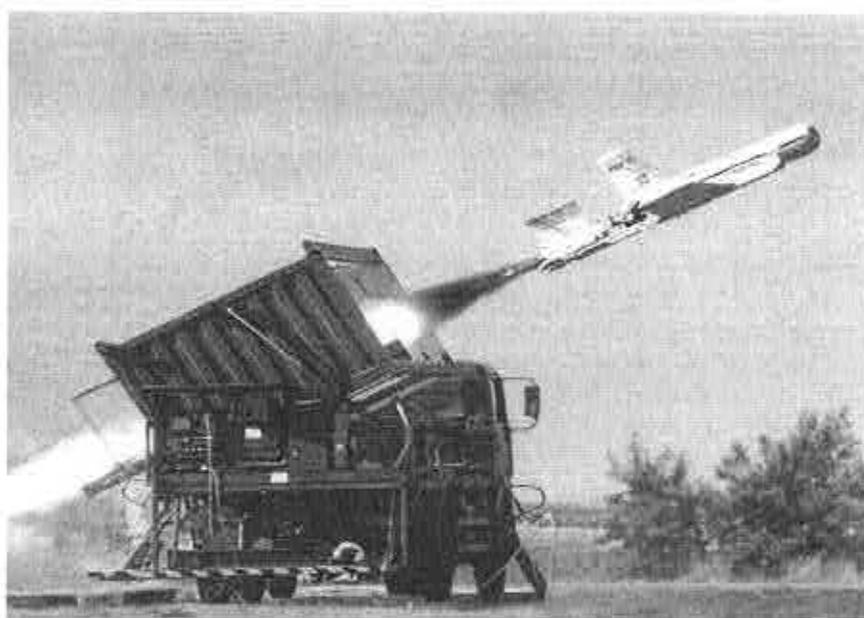
**FIG 3.2.2** Sistema de lançamento da aeronave não tripulada *Brevel*
