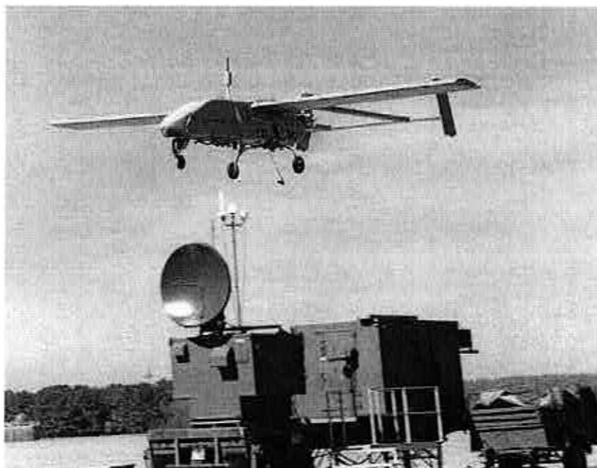
FIG 3.1.1 - VANT *Pioneer* e estação de controle terrestre
