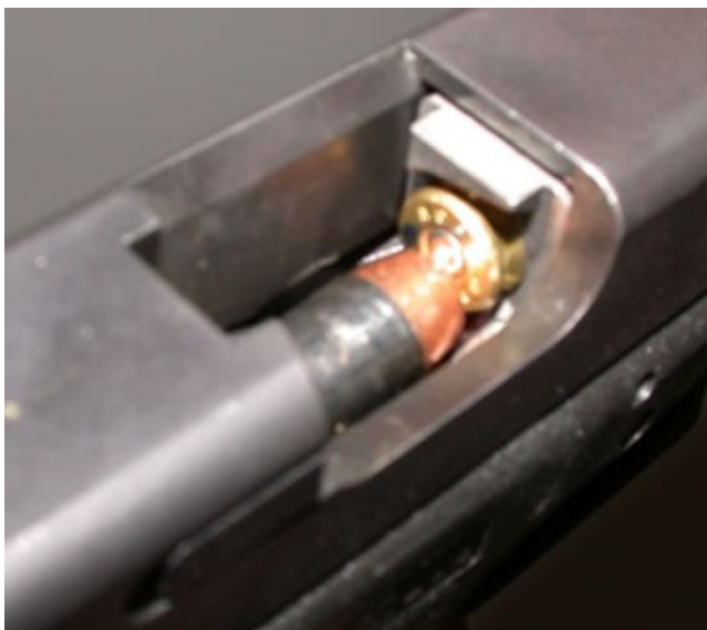
Figura 2: ilustração de uma pane de duplo carregamento.
