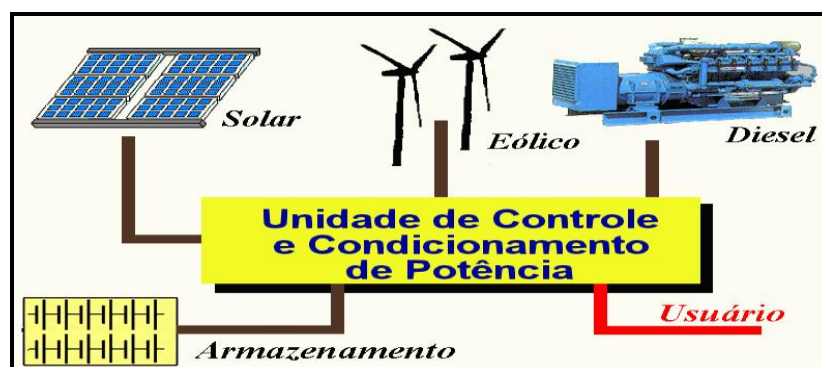
Figura 1 – Sistema Híbrido Fonte: CRESESB (2006)
