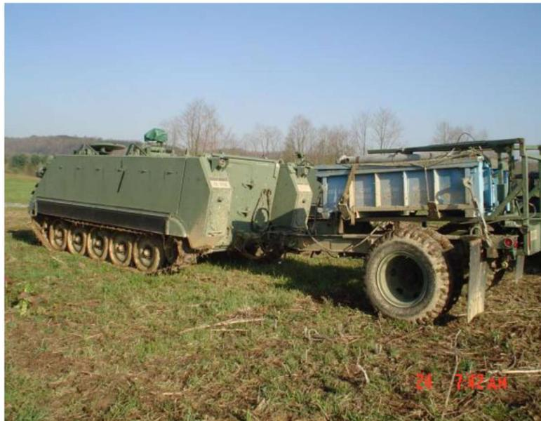
FIGURA 4 – MICLIC rebocado por um M-113
