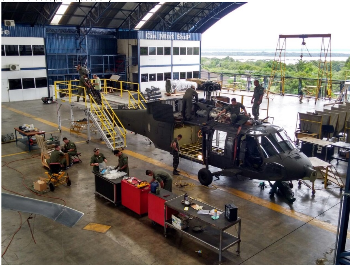
FOTO 1: Inspeção de 500 HV da aeronave EB3004 realizada no ano de 2017.
