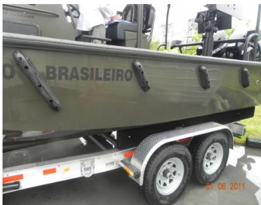
FIGURA 5 e 6: defensas laterais em borracha e reforço metálico FONTE: CECMA
