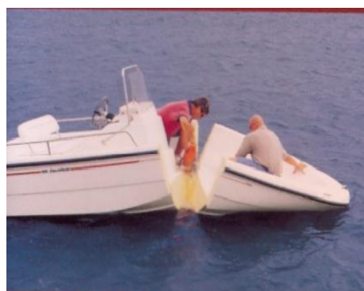
FIGURA 3 e 4: Casco de fibra de vidro injetado insubmergível FONTE: Boston Whaler
