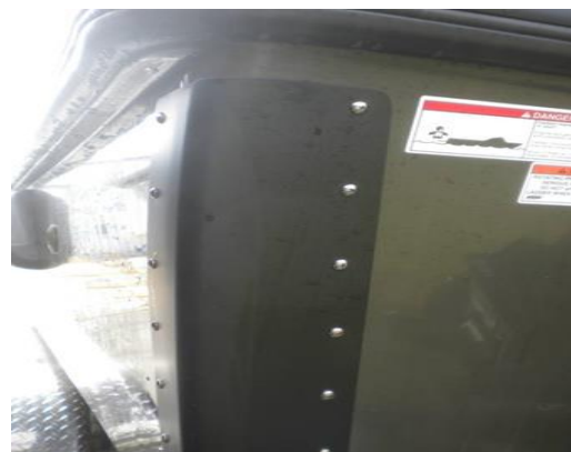
FIGURA 5 e 6: defensas laterais em borracha e reforço metálico FONTE: CECMA
