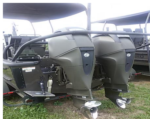
FIGURA 7 e 8: flaps de compensação eletromecânico e Motores de popa Mercury Verado 4T de 200HP FONTE: CECMA
