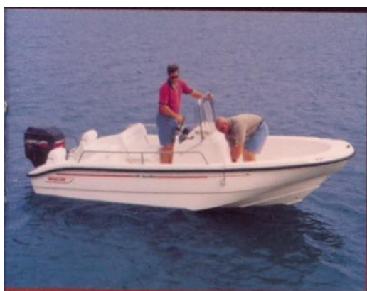
FIGURA 3 e 4: Casco de fibra de vidro injetado insubmergível FONTE: Boston Whaler
