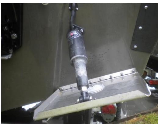
FIGURA 7 e 8: flaps de compensação eletromecânico e Motores de popa Mercury Verado 4T de 200HP FONTE: CECMA
