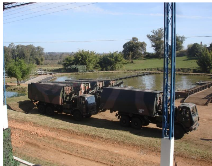
FIGURA 6 – Suportes Flutuantes da Ponte FFB 2000 Krupp Fonte: ( paolipc.blogspot.com/2012/07/engenharia-do-exercito-lanca-primeira.html )
