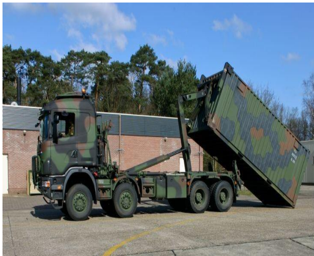
FIGURA 3 – Container Oficina da Ponte Anfíbia Flutuante M3
