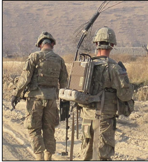
Figura 3 – Sistema Thor III (à direita), para proteção do trabalho da equipe EOD.
