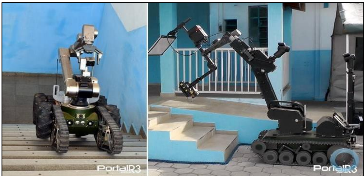
FIGURA 5 – Robô TELEMEX, à esquerda, e TEODOR, à direita.
