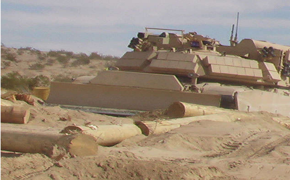
FIGURA 5 Veículo de Assalto de Brecha M1 com lâmina
