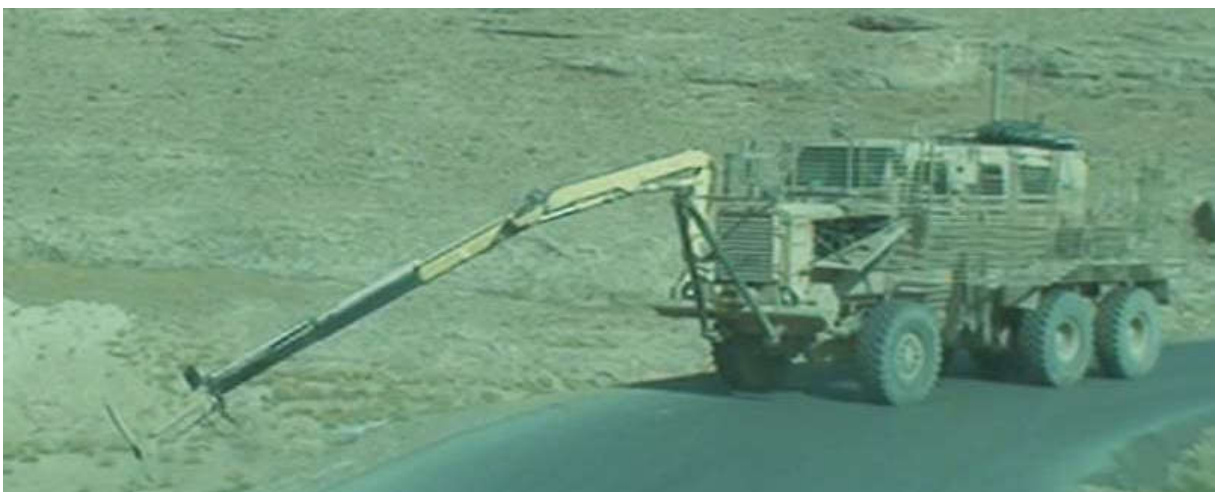
FIGURA 3 Viatura Pesada de Limpeza Mine-protected Vehicle (MPCV) Buffalo
