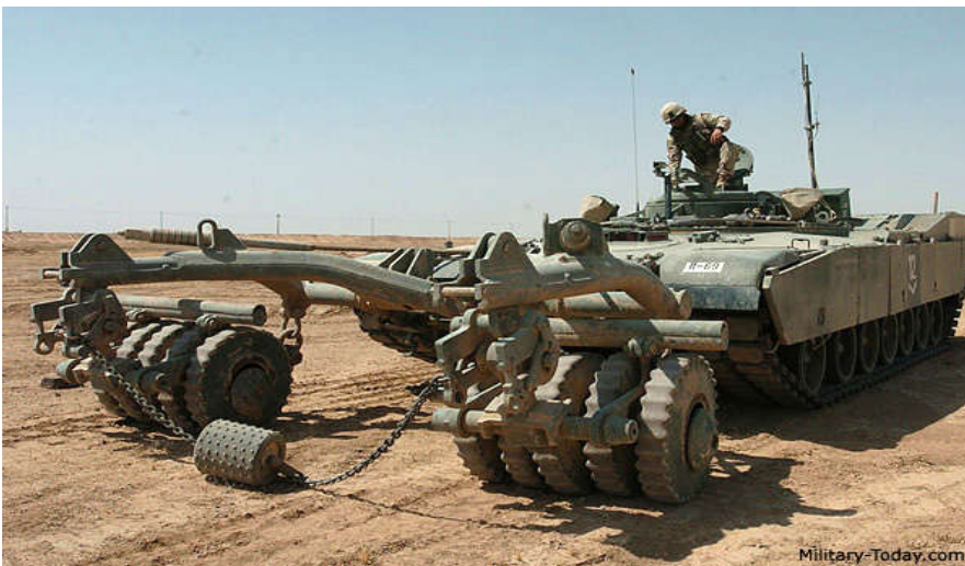
FIGURA 6 Veículo de Assalto de Brecha Panther com rolo
