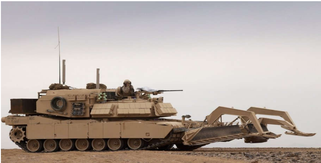
FIGURA 4 Veículo de Assalto de Brecha M1 com arado e carga linear explosiva
