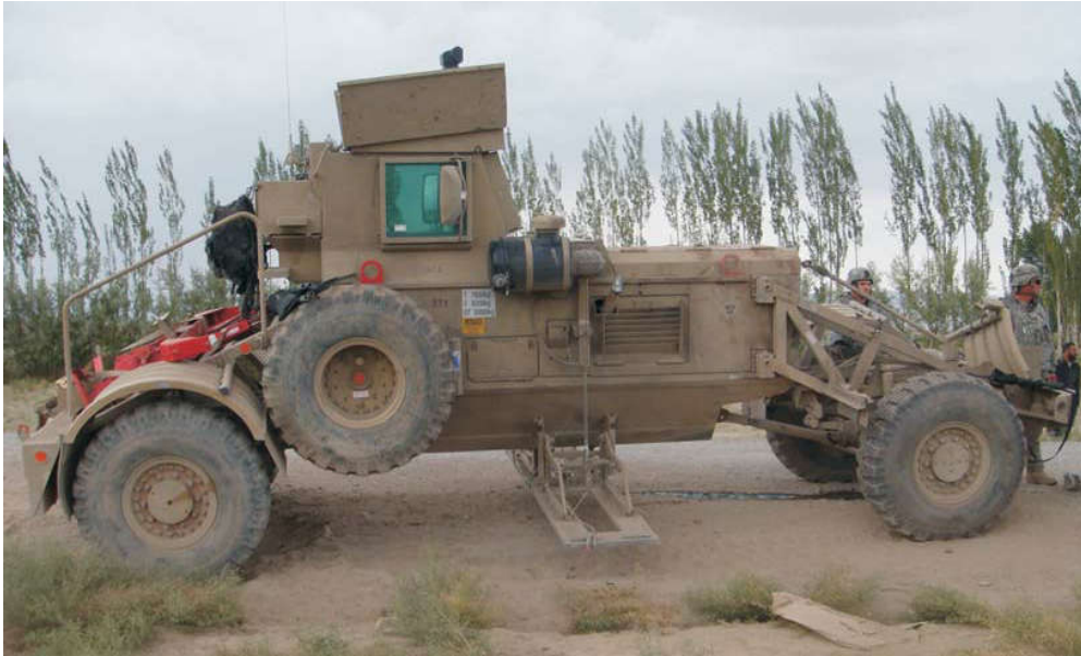
FIGURA 2 Viatura de Detecção Interim Vehicle-mounted Mine Detector (IVMMD) Husky
