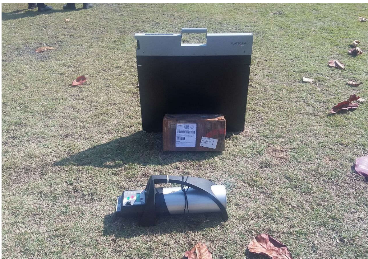
Figura 04 – Equipamento de Raios - X
