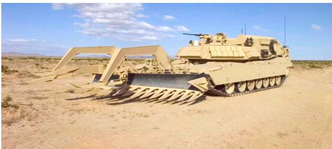
**FIGURA 3** – Carro de Combate M1A1 com equipamento arado.
