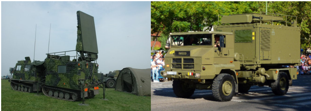
Figura 3 – imagem ilustrativa das possibilidades de se montar o ARTHUR sobre uma plataforma de lagarta ou sobre rodas.
